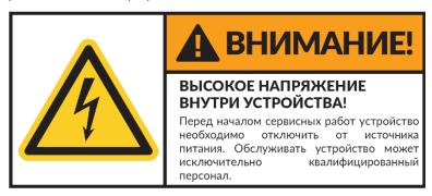
Высокое напряжение внутри устройства опасно для здоровья человека. В случае поражения электрическим током с аналогичными как в устройстве параметрами могут возникнуть ожоги кожи, мышечные спазмы, потеря сознания и, в крайних случаях, остановка сердца. Поэтому все сервисные работы могут начинаться только после отключения устройства от источника питания и выполняться исключительно квалифицированным и прошедшим соответствующее обучение персоналом!
